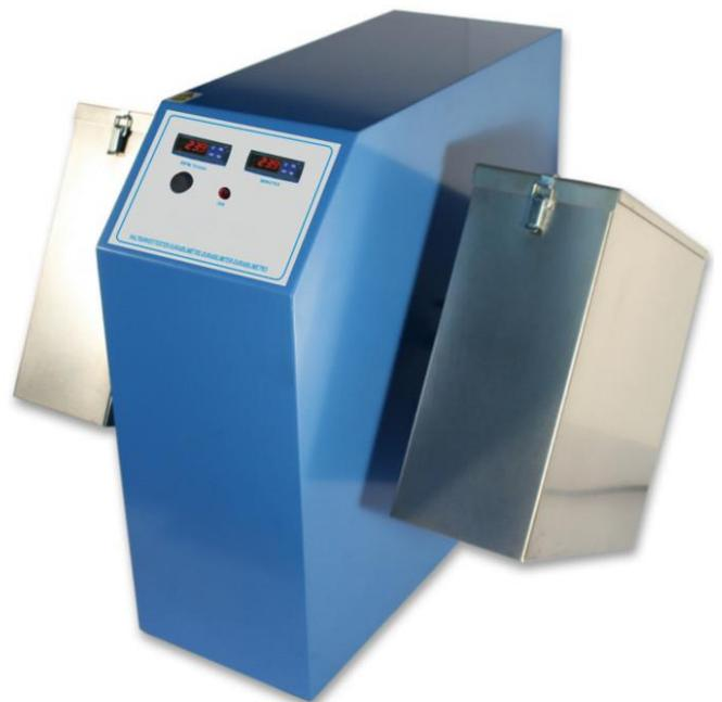
El **durabilímetro PDT-EN15** es un método de análisis de la Durabilidad de pellets, granulados, conglomerados, terrones, grumos, terrones de azúcar y productos similares.
